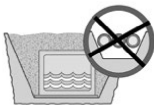
Fig. A galleria di deflusso.
